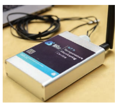
ชุดอุปกรณ์พร้อมระบบตรวจวัดอุณหภูมิและควบคุมห่วงโซ่ความเย็น (IoT Cold Chain)
