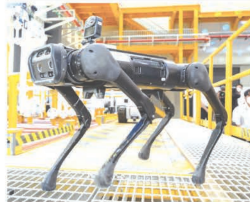
หุ่นยนต์สำหรับสำรวจและตรวจสอบ และหุ่นยนต์ปฏิบัติการบนแท่นขุดเจาะปิโตรเลียมออกชายฝั่ง
