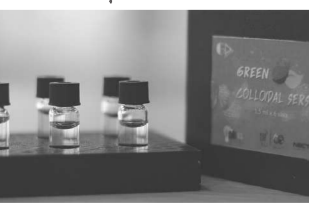
นวัตกรรม “Green colloidal SERS” สำหรับจำแนกหมึกปากกาในงานตรวจพิสูจน์เอกสารต้องสงสัย
